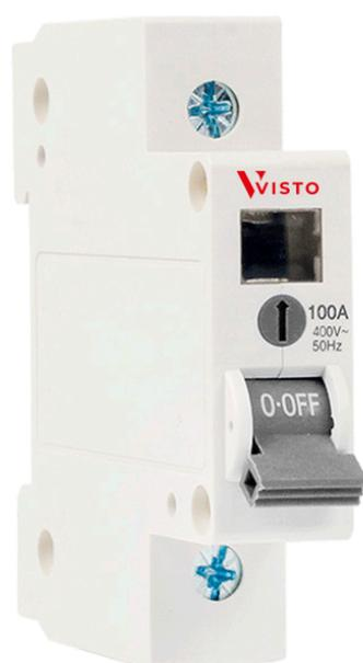
Выключатели нагрузки предназначены для управления и коммутации цепей под нагрузкой, разъединения цепей. Используются в цепях переменного тока частотой 50 Гц, номинальным напряжением до 250-500 В и максимальным рабочим током до 125 А.
