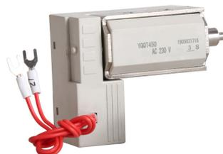
Когда реле минимального напряжения не включено, автоматический выключатель не может быть переведен в рабочее положение. Реле минимального напряжения для автоматических выключателей с номинальным током 2500A и выше предлагается двух типов: отключение без функции задержки и отключение с временной задержкой.
