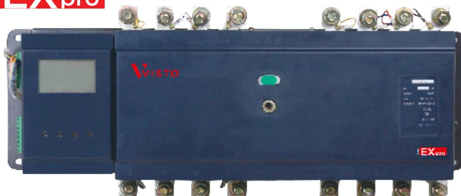
Автоматический переключатель резерва VISTO серии EXpro-AR применяется к дублирующей системе электропитания переменного тока 50 Гц. Номинальное напряжение, однофазное 230 В или трехфазное, четырехпроводное 400 В, номинальный ток до 800 А.
