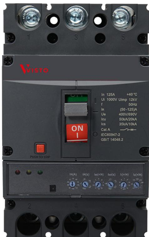
Автоматический выключатель в литом корпусе электронного типа серии EXpro-ME применяется в цепях с частотой переменного тока 50 Гц, номинальным напряжением до 690 В и номинальным током до 800 А для защиты от перегрузки, пониженного напряжения, короткого замыкания. Его также можно использовать для нечастого запуска двигателя.
