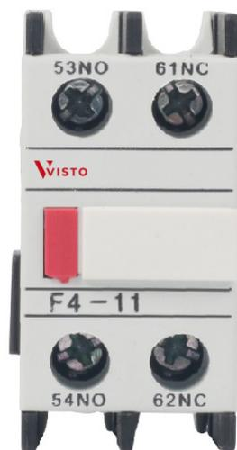
Вспомогательная контактная группа F4 в основном используется в цепи управления с переменным током 50 Гц, категорией применения AC-15, номинальным рабочим напряжением до 380 В переменного тока, номинальным током до 0,95 А или категорией применения DC-13, номинальным рабочим напряжением до 220 В постоянного тока и номинальным током до 0,15 А для управляющего сигнала и электрической блокировки.
